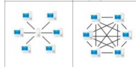
Bei einem Peer-to-Peer-Netz genügt es nicht mehr, einen einzelnen Server stillzulegen, um die Kommunikation vollständig zu unterbrechen.
